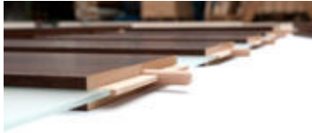
Stabiles Querteil mit Dicke 35 mm oder 22 mm
